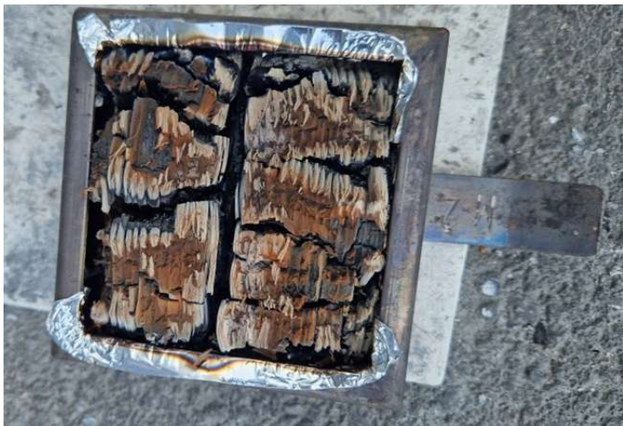
Slika 2: Vzorec v držalu že zavito v aluminijasto folijo in pripravljen za testiranje (zgoraj) vzorec po testiranju (spodaj) (foto: arhiv Matevž Vrhovec)
