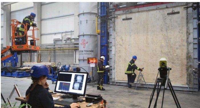
Slika 1: Optični merilni sistem za meritev pomikov, v ozadju nameščena stena pred pričetkom požarnega preskusa, foto: arhiv ZAG.
