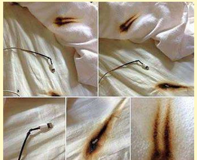
Slika 5: Ožgana posteljina zaradi pokritega poškodovanega kabla za polnjenje prenosnega telefona med spanjem. Vir: FB stran gasilske enote Newton, New Hampshire, ZDA
