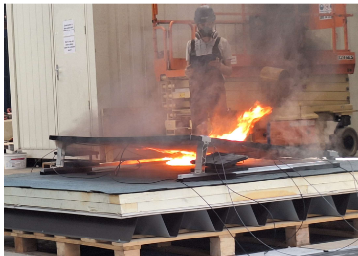
Slika 4: Požarni preskus v Požarnem laboratoriju ZAG, Logatec 2025 (foto: arhiv Zarja Elektronika)
