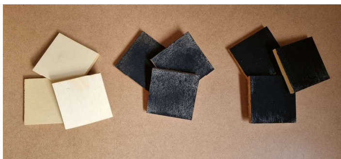
Slika 4: Smrekov les z nanosom oljnega premaza (levo), z dodatkom 10 % biooglenega prahu (sredina) in z dodatkom 20 % biooglenega prahu (desno), osebni arhiv U. Blumauer.
