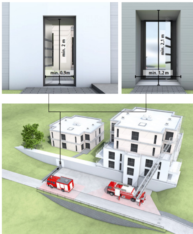
Slika 7: Najmanjše dovoljene svetle mere prehodov, skozi katere vodijo dostopne poti za gasilce
