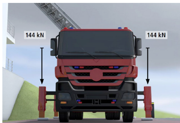
Slika 6: Računska obtežba na postavitveni površini nad kletjo pri stabilizaciji gasilske lestve: 144 \text{ kN} na podporno površino 0,18 \text{ m}^2
