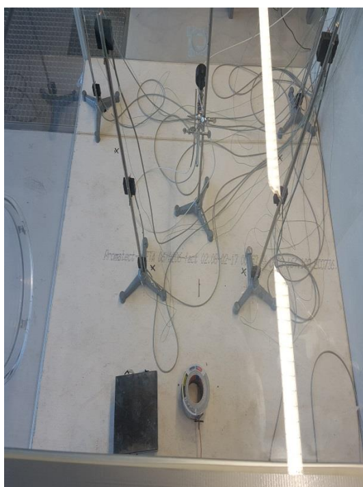
Slika 6: Komora za opravljanje meritev nastajanja in gibanja CO po prostoru, merjenje temperature in ostalih izbranih parametrov pri gorenju različnih goriv pri različnih pogojih
