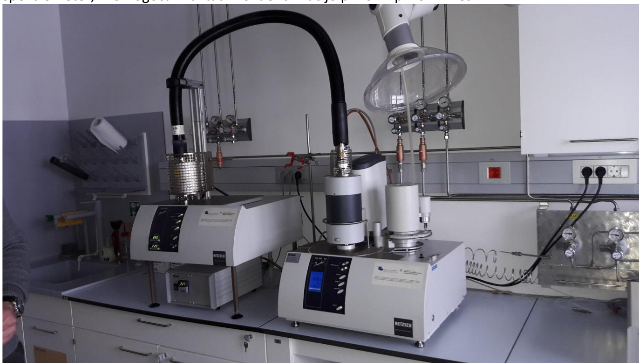
Slika 4: Aparatura za simultano termično analizo STA 449 F3 Jupiter, ki je preko kvarčne ( \text{SiO}_2 ) kapilare sklopljena s štiripolnim masnim spektrometrom (QMS)
