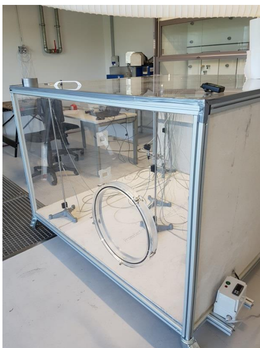
Slika 6: Komora za opravljanje meritev nastajanja in gibanja CO po prostoru, merjenje temperature in ostalih izbranih parametrov pri gorenju različnih goriv pri različnih pogojih
