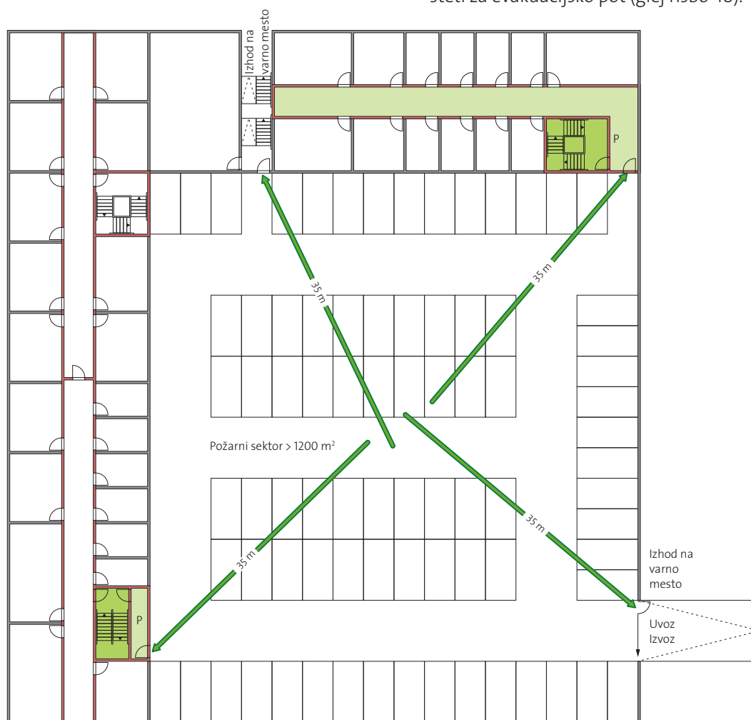
Risba 48: Prikaz izvedbe evakuacijskih poti v garažni stavbi s predprostori pred zaščitnimi stopnišči
